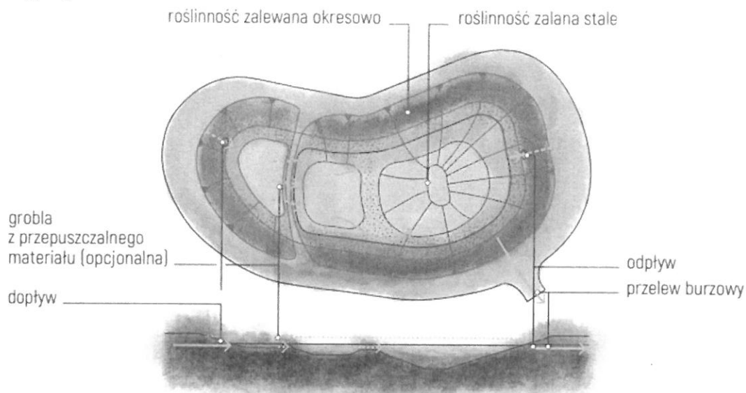
Rysunek 53. Schemat typowego stawu retencyjnego, widok z góry i przekrój
