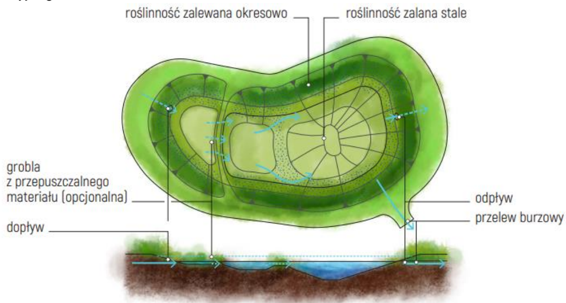
Rysunek 53. Schemat typowego stawu retencyjnego, widok z góry i przekrój
